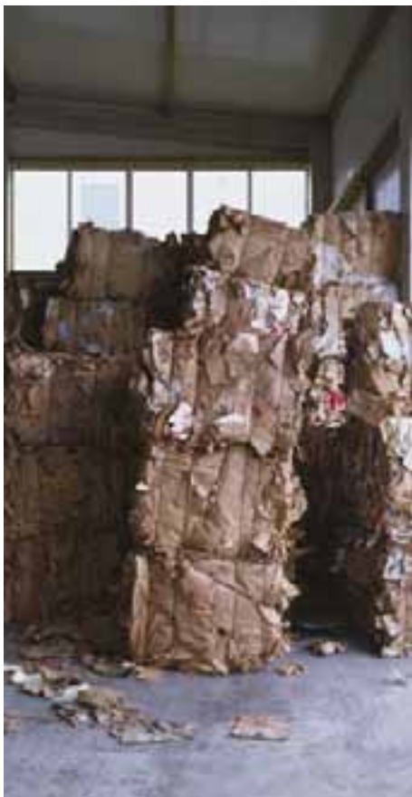
Wichtiger Bestandteil unserer Calciumsulfat-Platten sind Cellulosefasern, die wir aus Recycling-Papier gewinnen
